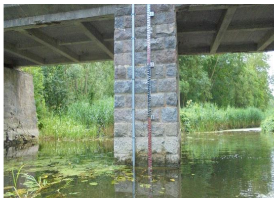
13. attēls. Hidrometriskais postenis Ežezers- Ezernieki (kreisā pusē) un postenis Vircava – Lielvircava (labā pusē)
